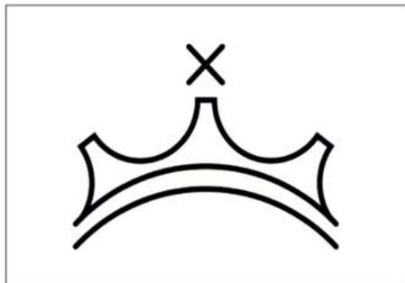
В обоих случаях необходимо отрегулировать ход цепи. Одновременно проверьте износ ведущей и задней звезды. Если он чрезмерный, замените весь узел, переднюю и заднюю звезду вместе с цепью.
