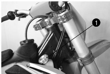
Водяной насос в двигателе обеспечивает циркуляцию охлаждающей жидкости. Давление, возникающее из-за нагрева системы охлаждения, регулируется клапаном в крышке радиатора. Это гарантирует, что эксплуатация транспортного средства при указанной температуре охлаждающей жидкости не приведет к риску возникновения неисправностей.
