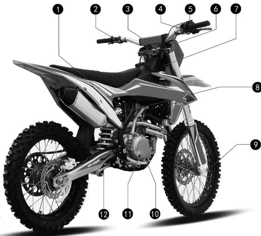
1. Регулировка сжатия амортизатора
