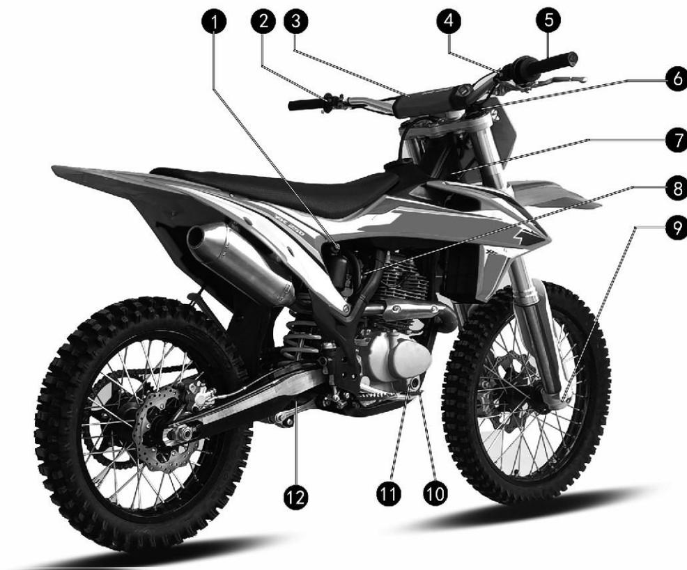
1. Регулировка сжатия амортизатора
